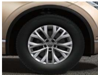
Легкосплавные колесные диски Cascade 8J x 18 - стандарт для Respect
